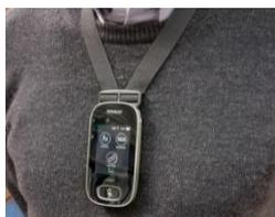
Die hauptsächlich sprechende Person trägt ein Sendermikrofon, welches die Sprachsignale auffängt und diese Informationen digital an die Empfänger des hörbereinträchtigteten Kindes sendet. Diese Empfänger werden von dem Hörgeräteträger hinter dem Ohr an den Hörgeräten oder um den Hals getragen.
